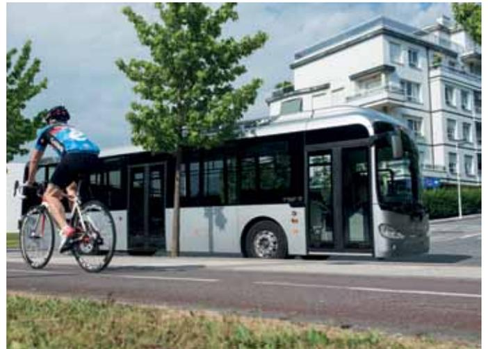
réduite entre le sol et le plancher, de 340 mm maximum, permet également une plus grande accessibilité.
