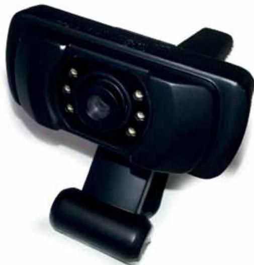
Il consiste à surveiller les paupières et les mouvements des yeux et de la tête afin de détecter des actions anormales qui conduisent à des réactions de risque de la part du conducteur. Dans ce cas, les alarmes d'avertissement au conducteur s'activeront.
