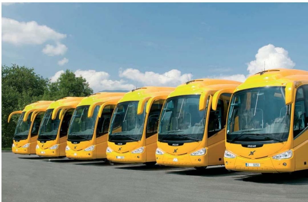
Il s'agit de 20 autocars modèle IRIZAR PB de grand luxe, fabriqués sur châssis de la marque Volvo B13 PX 6x2 SI VTL Euro5, de 15 mètres de longueur, équipés de 63 sièges, WC et distributeur de café automatique à pièces. Les sièges,
